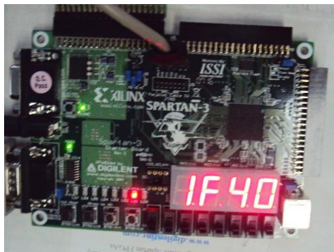
Figura 3 Lectura de cuentas del encoder al terminarse una revolución positiva
